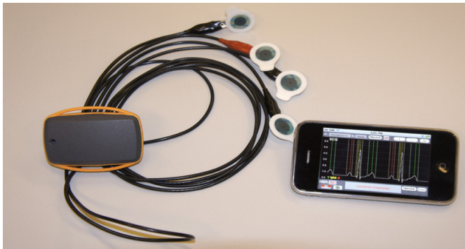
Prototypé de laboratoire avec électrodes séparées.
