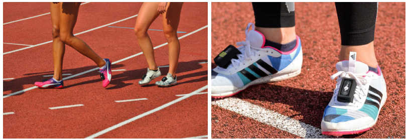
Unités de mesure inertes portées au pieds (Physilog 5).
