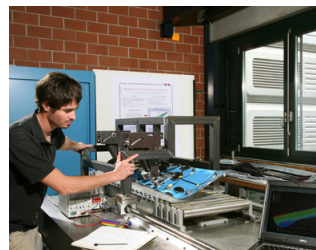
Banc d'essai du snowboard instrumenté.
